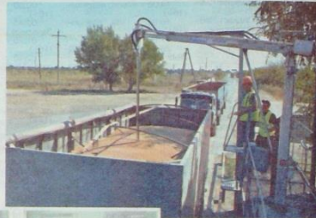
С помощью автоматического пробоотборника идет забор зерна для исследования.
